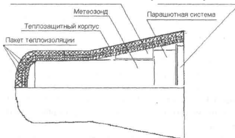
Рис. 2. Конструктивно-компоновочная схема СК КБ "Салют"
