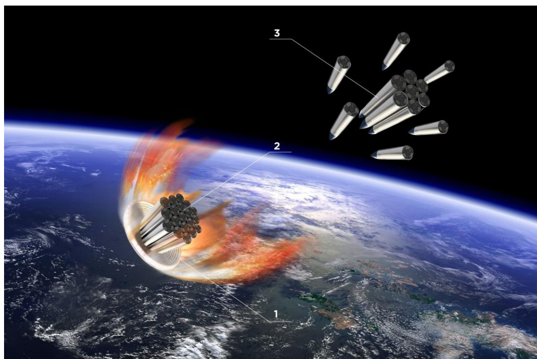
Рис. 4. Принцип сокращения удельной массы теплозащиты вторых ступеней РН за счет использования общего теплозащитного экрана для ракетного пакета: 1 – аэродинамический теплозащитный экран; 2 – пакет вторых ступеней ракет-носителей в процессе спуска с орбиты; 3 – пакет вторых ракетных ступеней на этапе сборки перед соединением с общим защитным экраном. (Майборода, 2025).
