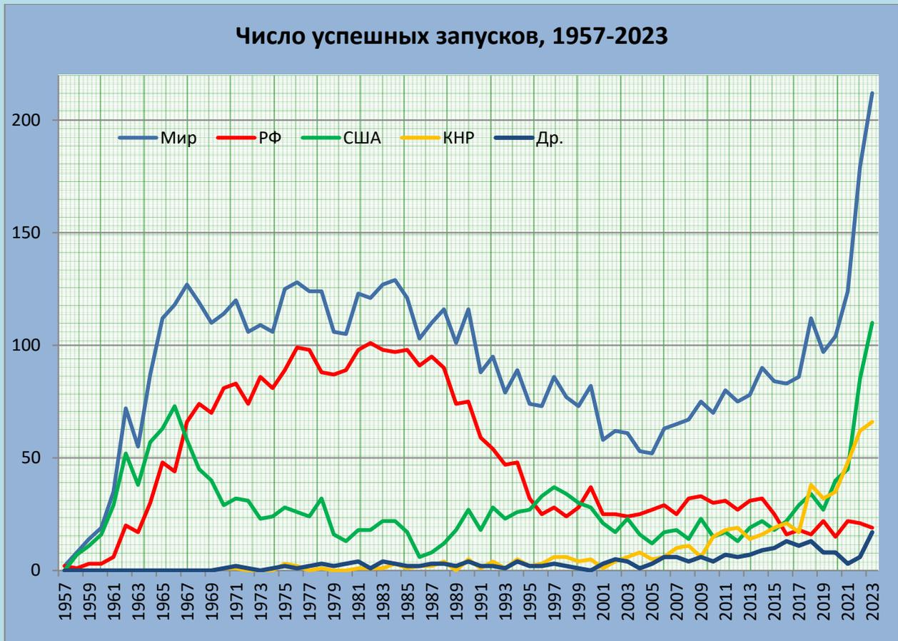
Рис. 1. Интенсивность успешных запусков космических РН
